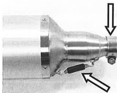
Innestare il collettore secondario nel terminale, ancorare la molla ed alloggiare la fascetta di serraggio
