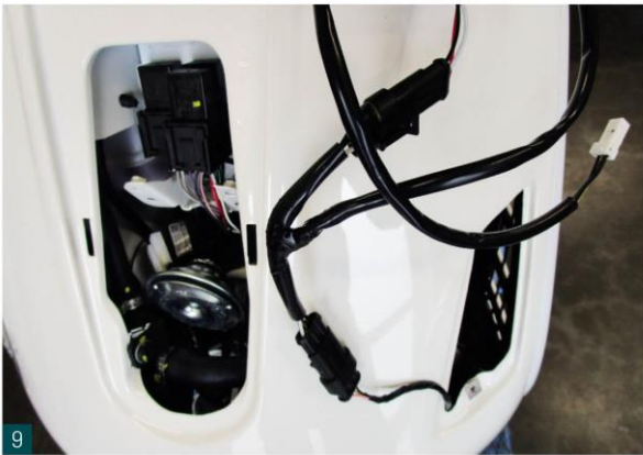
Bei Fahrzeugen von Bj. 2014-2018: Adapter für Tagfahrlicht einfügen. For scooters with year of construction from 2014 to 2018 use adapter for daytime running lights.
