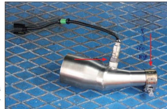
Alloggiare la fascetta nell'innesto del raccordo ed avvitare la sonda lambda
