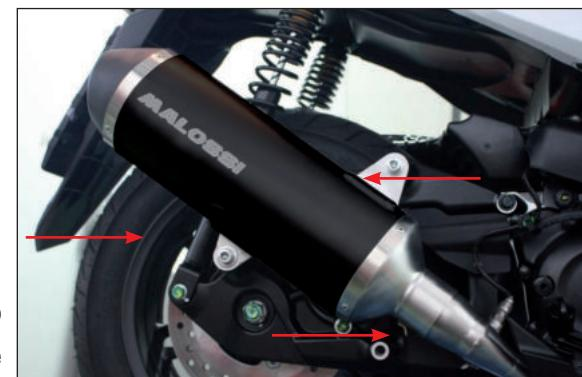
Innestare il terminale e serrare gli attacchi (2) al telaio
