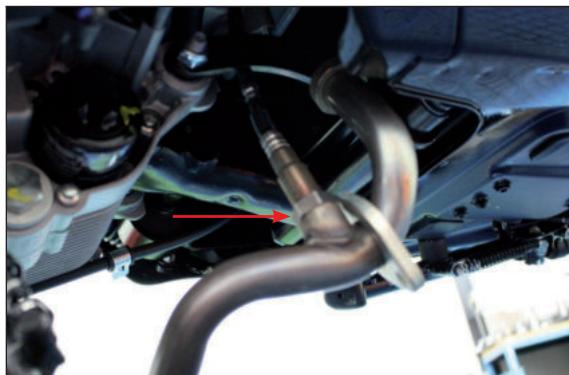
Svitare la sonda lambda e rimuovere il collettore
