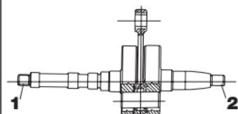
**Attention:** Serrez les écrous du variateur et du volant (1-2, Fig. 7) avec une clé dynamométrique pour une couple de serrage de 40Nm (4Kgm).
