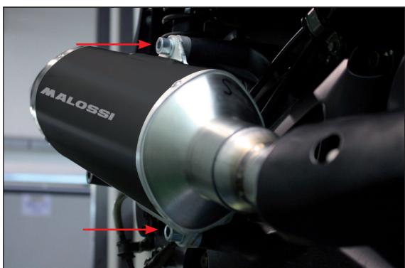
Innestare il terminale e serrarlo interponendo tra attacchi e telaio gli spessori forniti
